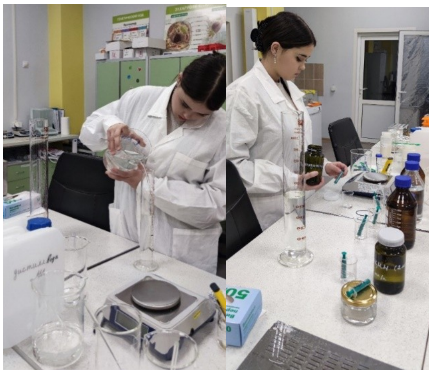
Рис.6 Приготовление питательной среды Мурасиге-Скуга.
