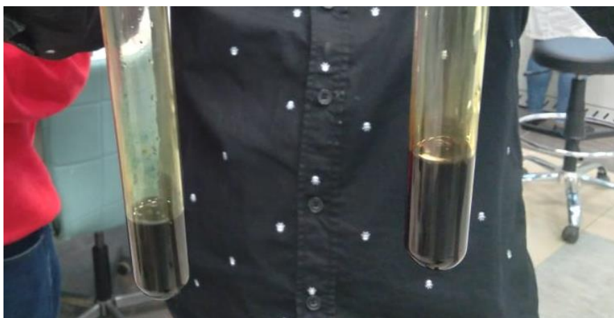
Рисунок 2.4 – Качественная реакция на присутствие хлорида железа II ( \text{FeCl}_2 )
