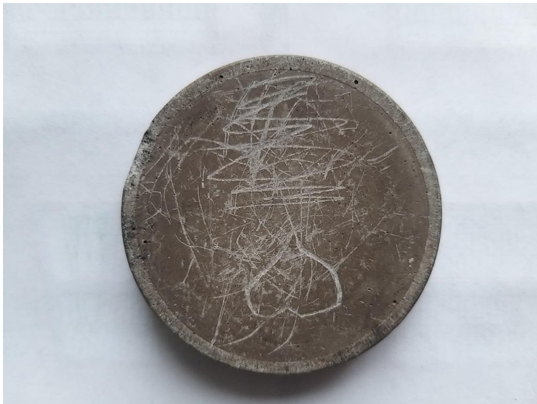
Рисунок 2.10 – Образец магнитоактивного материала на основе гипсового вяжущего
