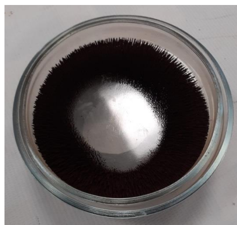
Рисунок 2.8 – Магнетит, полученный после промывания и сушки
