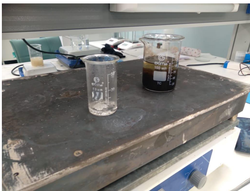
Рисунок 2.5 – Осаждение оксидов железа II и III насыщенным щелочным раствором едкого натрия ( \text{NaOH} )
