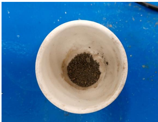
Рисунок 19 – Изготовленный оксид олова (II) \text{SnO}_2
