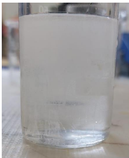
Рисунок 11 – Осаждение кремниевой кислоты из жидкого натриевого стекла при помощи уксусной кислоты
