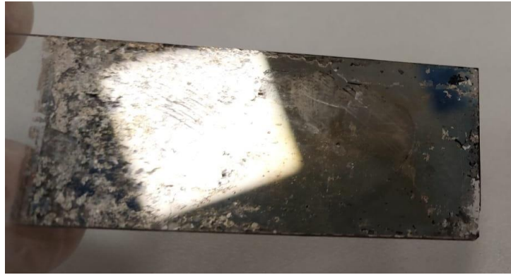
Рисунок 16 – Поверхность диэлектрика после процесса вжигания наночастицсеребра
