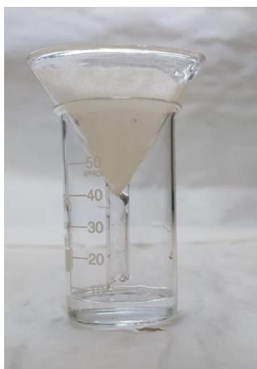
Рисунок 6 – Фильтрование горячего насыщенного раствора борной кислоты
