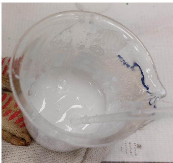
Рисунок 12 – Полученный гель кремниевой кислоты
