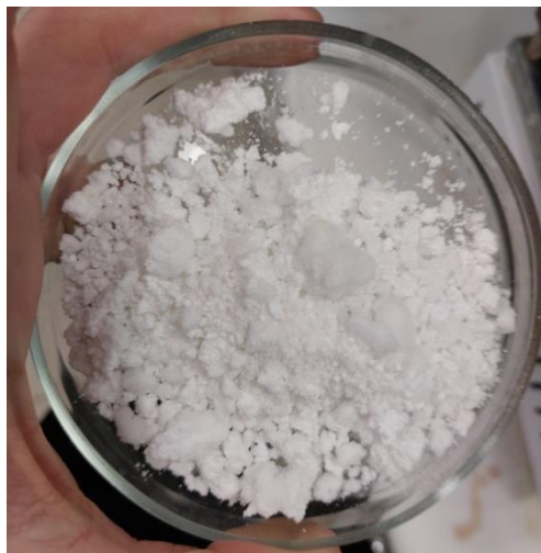
Рисунок 13 – Порошок оксида кремния
