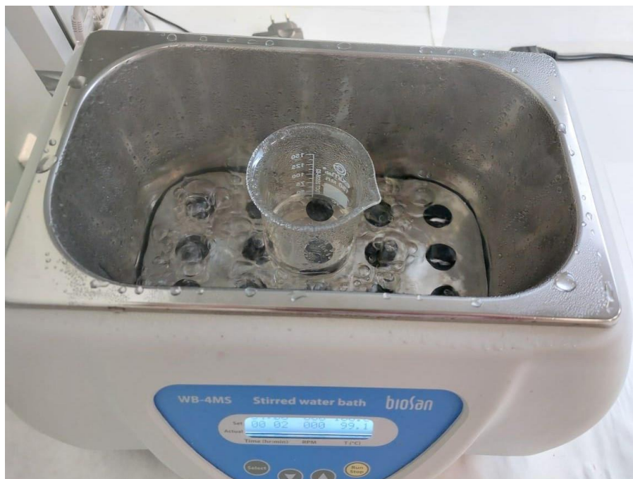
Рисунок 7 – Упаривание раствора борной кислоты
