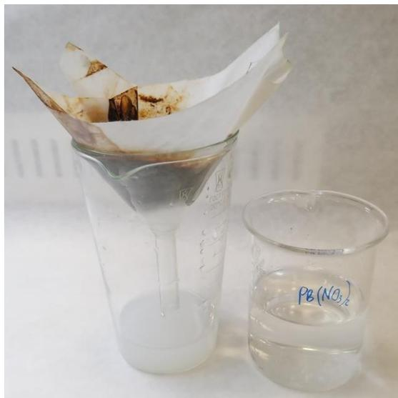
Рисунок 2.3 – Фильтрация и промывание осадка  $\text{Fe}(\text{OH})_2$  с выполнением качественной реакции на присутствие сульфат-ионов
