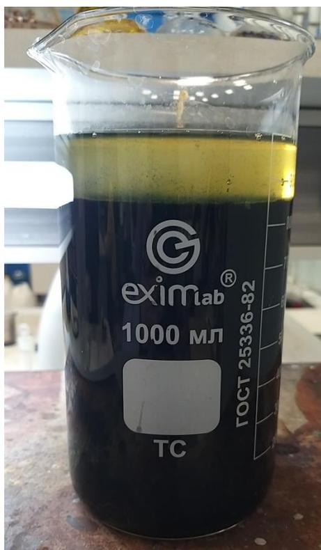
Рисунок 2.6 – Смешивание растворов исходных реактивов с образованием магнетита  $\text{Fe}_3\text{O}_4$
