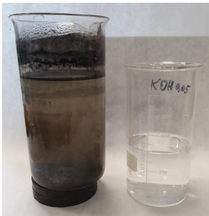
Рисунок 2.7 – Магнитная сепарация и промывка  $\text{Fe}_3\text{O}_4$
