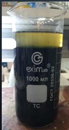
Смешивание растворов исходных реактивов с образованием магнетита Fe 3 O 4
