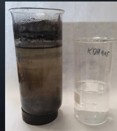
Магнитная сепарация и промывка Fe 3 O 4
