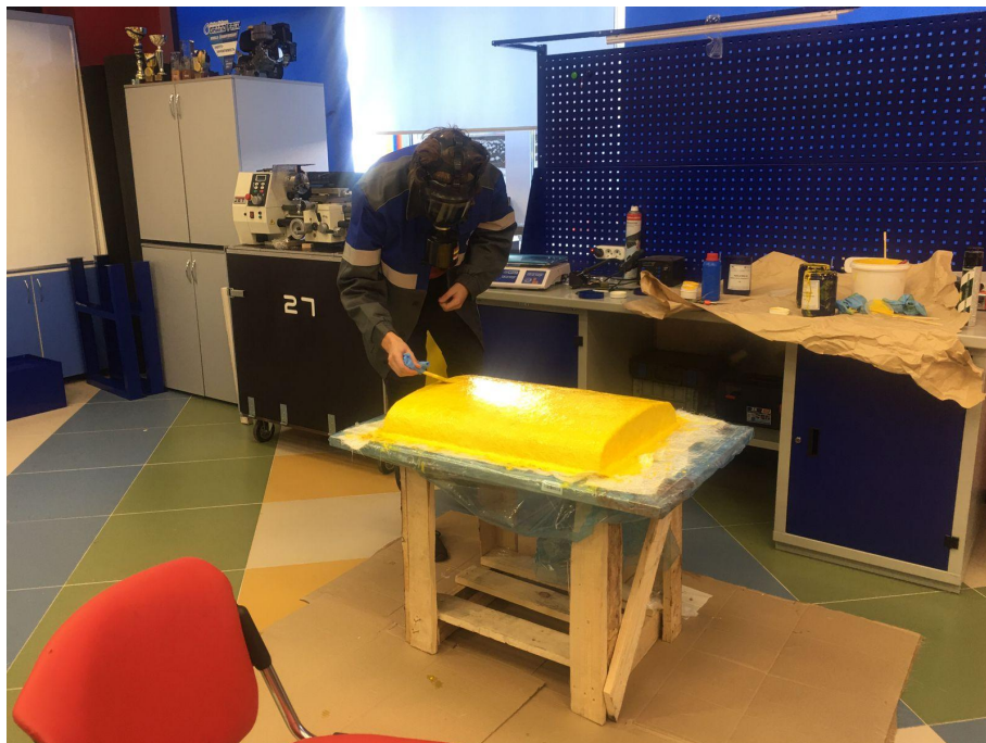
Рисунок 7 - Нанесение смолы на стекломат
