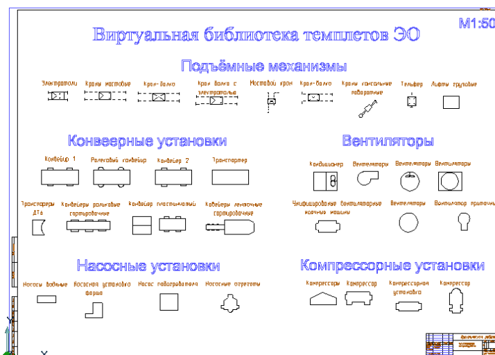
Рисунок 2а - Шаблон виртуальной библиотеки темплетов промышленного оборудования (продолжение)
