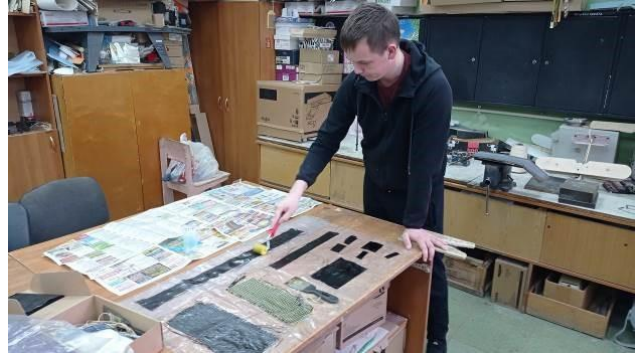
(Рис.2). Пропитка материалов эпоксидной смолой
