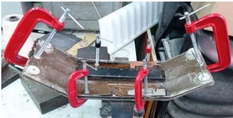
(Рис.3). Склеивание двух половинок в матрице
