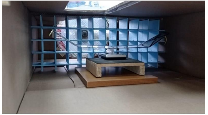
(Рис.2). Процесс проведения эксперимента в аэродинамической трубе с крылом из матрицы
