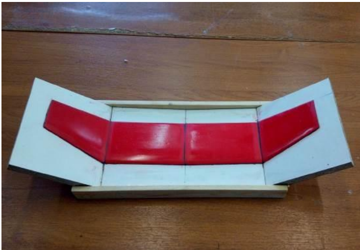
(Рис.5). Подготовленная «Болванка» перед началом создания матрицы
