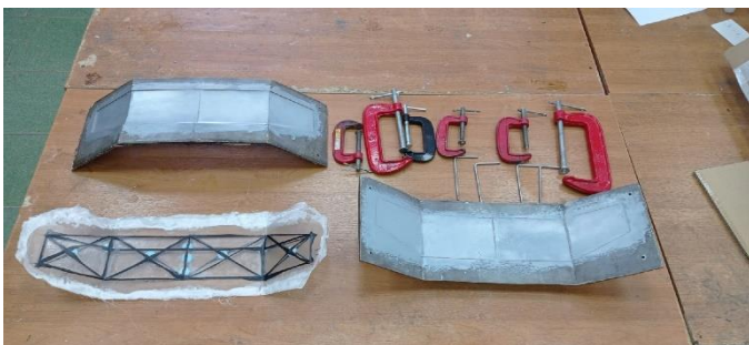
(Рис.7). Полуготовое изделие из стеклоткани
