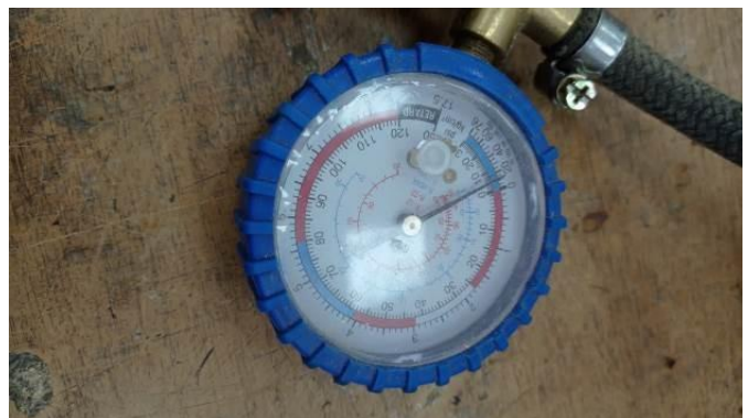
(Рис. 8). Показания манометра (давление в полиэтиленовом мешке меньше атмосферного давления.)
