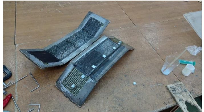
(Рис. 2). Подготовка к склеиванию половинок (консолей)
