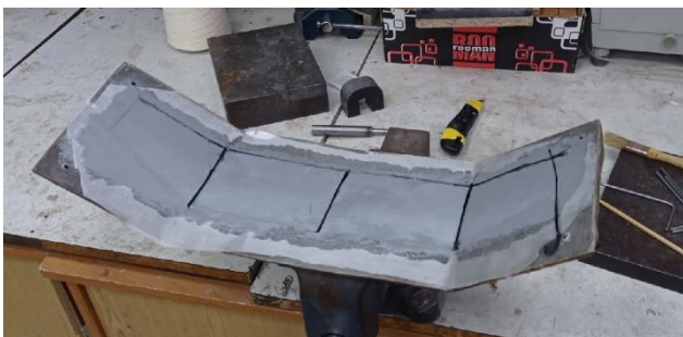
(Рис.5). Укладка силового набора.
