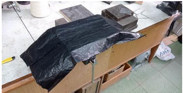
(Рис.4). Подготовка к вакуумной формовке
