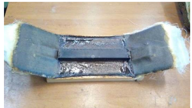
(Рис. 6) Завершение создания одной половинки матрицы (установка ребра жесткости (профильной трубы))
