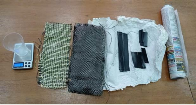
(Рис.1). Подготовленные материалы перед формовкой крыла. (Карбон (уголь), карбон/кевлар, угольное волокно)
