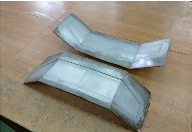
(Рис.4). Готовая матрица (в разборе)
