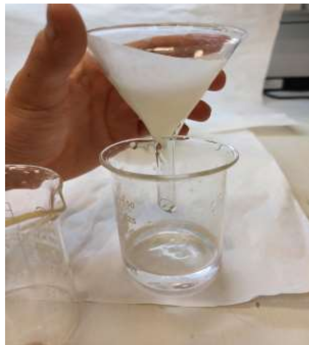
Фильтрация после водяной бани.
