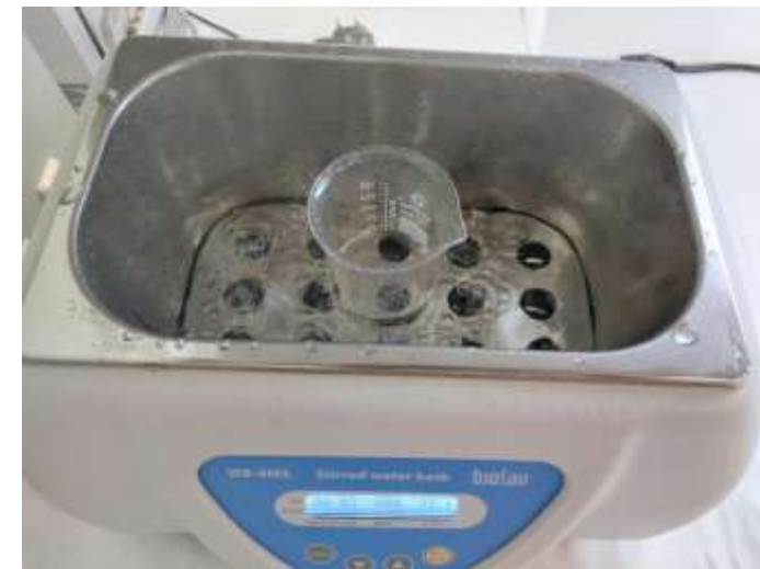
Упаривание в водяной бане фильтрат
