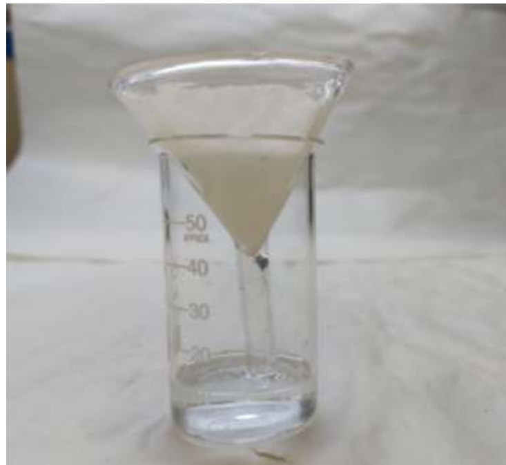
Фильтрация борной кислоты
