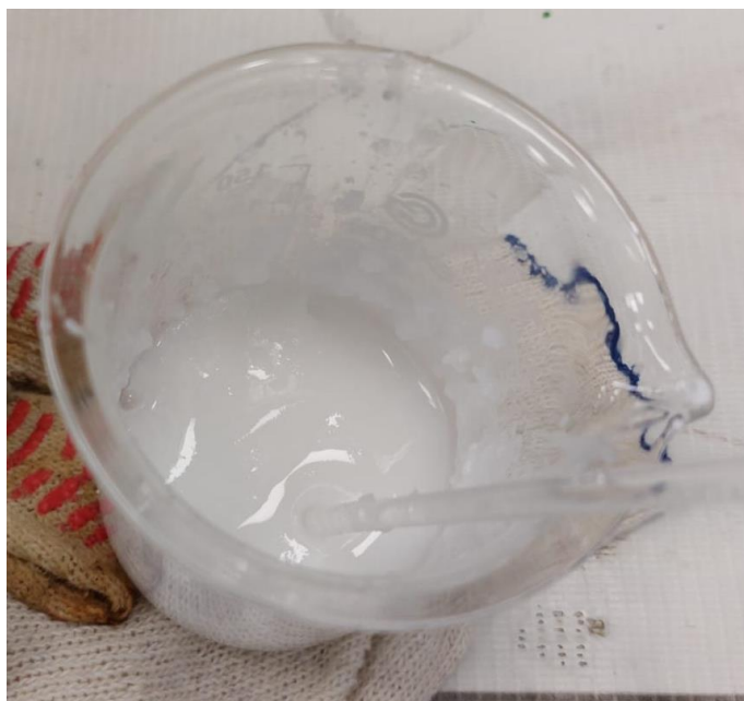
Рисунок 14 – Полученный гель кремниевой кислоты
