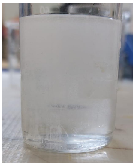
Рисунок 13 – Осаждение кремниевой кислоты из жидкого натриевого стекла при помощи уксусной кислоты
