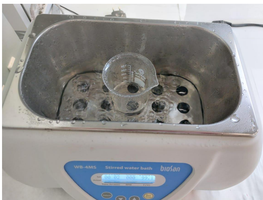
Рисунок 9 – Упаривание раствора борной кислоты
