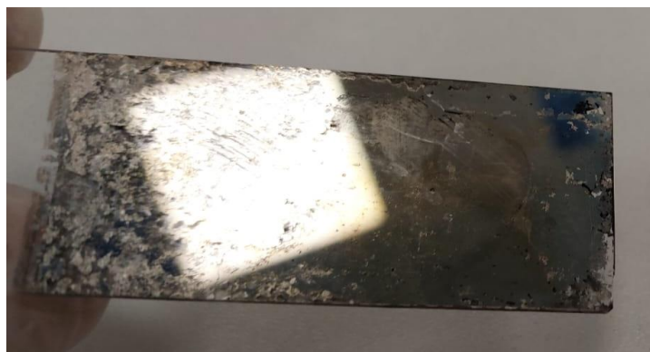
Рисунок 18 – Поверхность диэлектрика после процесса вжигания наночастиц серебра
