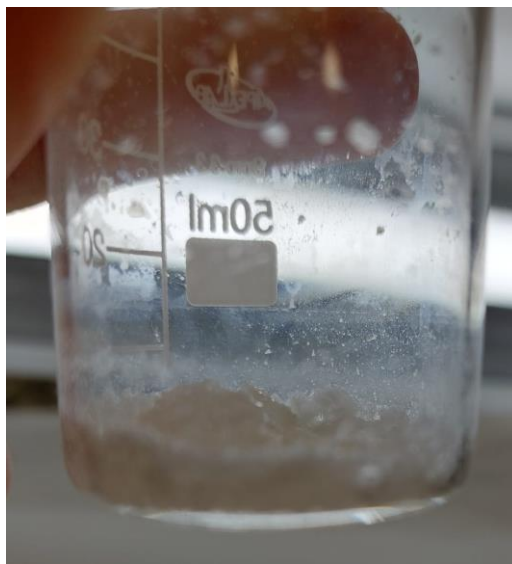
Рисунок 7 – Осадок борной кислоты
