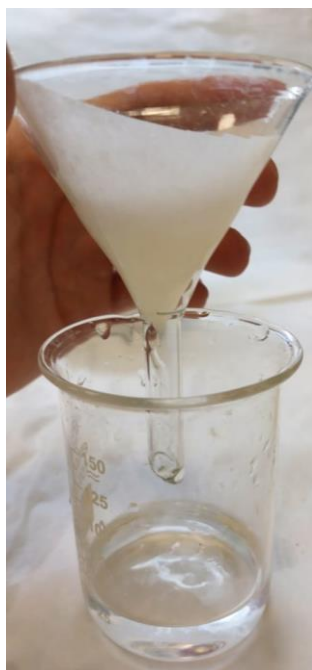
Рисунок 12 – Фильтрация и промывка перекристаллизованной борной кислоты
